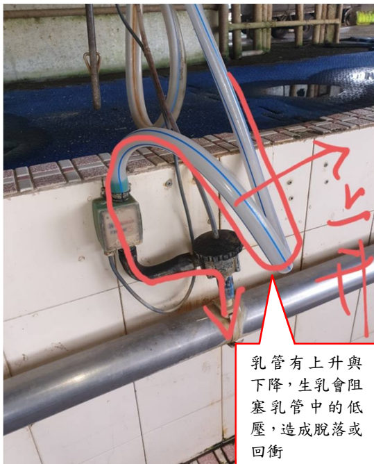
集乳座低壓開關橡皮圈老化，脫杯時無法關閉低壓
