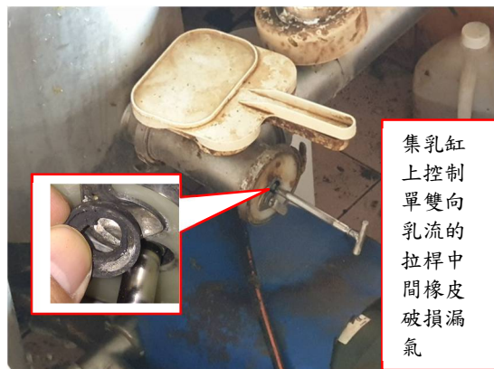
乳管有上升與下降，生乳會阻塞乳管中的低壓，造成脫落或回衝
