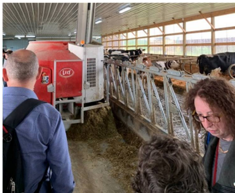
圖 19. 完全混合日糧自動給飼機於畜舍下料並推料
