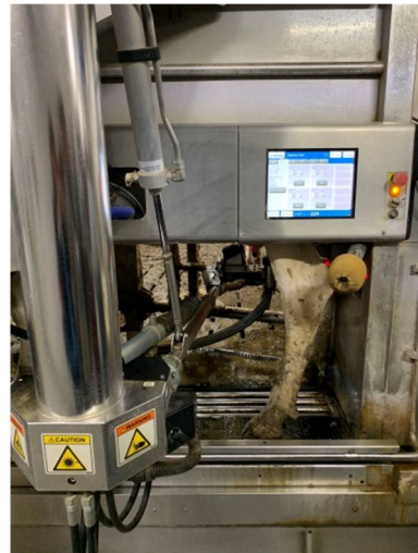
圖 16. Foremost 牧場使用 Delaval 機器人擠乳機現況及介面
