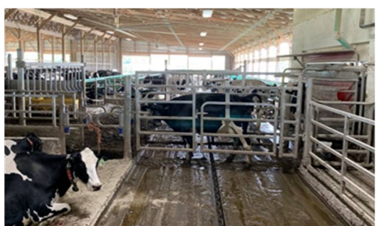
圖 6. Campbell 牧場使用三組 Lely 機器人擠乳機
