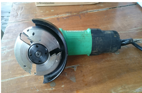
五吋砂輪機+鈦合金刀盤，刀盤上裝有可替換式刀片
