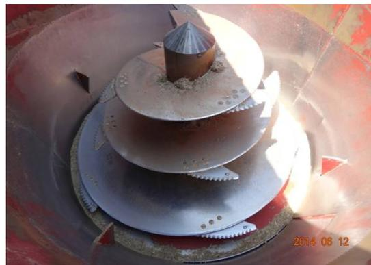
(圖一)、垂直式單攪拌器攪拌機【(右下、左下、以及左上艙壁各有一個突起物即為助切刀 (forage restrictor))】
