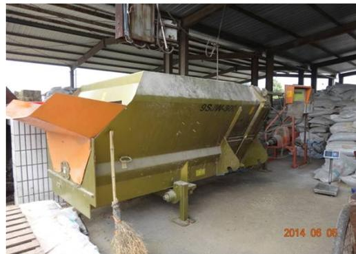
(圖五)、固定式鏟裝機 (電動馬達在右手邊)
