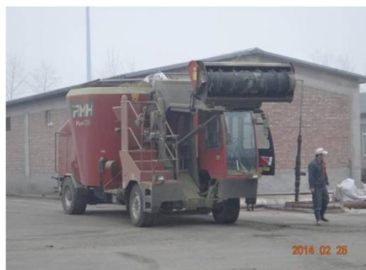
(圖四)、自走式攪拌機 (帶取料臂)
