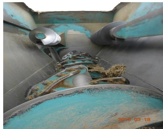
(圖二)、水平式攪拌機 (主攪拌器在中間，右上、左上為副攪拌器)
