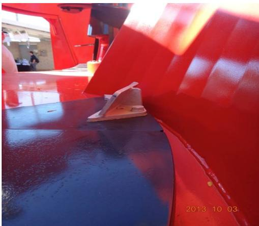
(圖六)、垂直式攪拌機其攪拌器底部的起腳板 (kicker plate)
